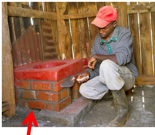
*Figura 7. Stufe casalinghe dotate alla base di piccoli fori per l'ingresso dell'aria*
