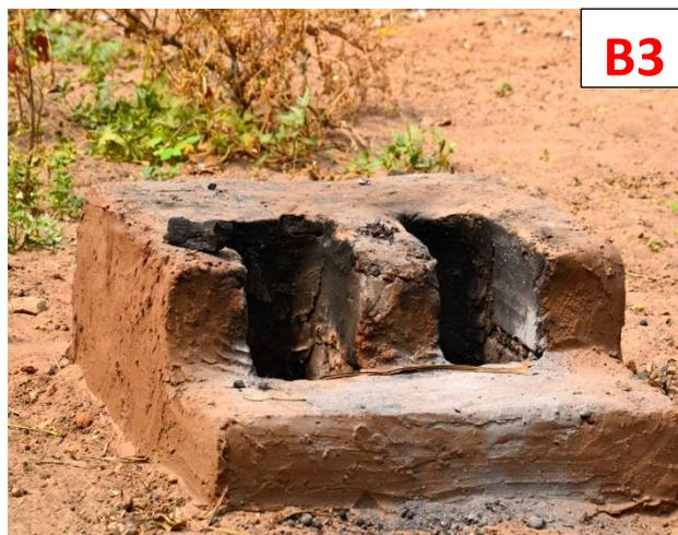
Figura 2. A capanna realizzata con materiale infiammabile; B1 vano con pareti non infiammabili ma privo di sbocchi verso l'esterno necessari per arieggiare; B2 e B3 fuochi congolesi migliorati sulla base di quanto già presente in India
