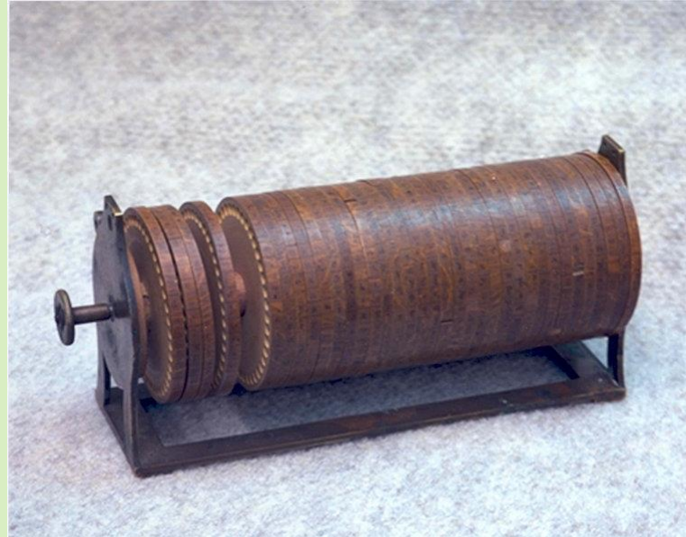
Disco di Jefferson (1790-1800) 36 dischi di legno 36! \approx 3.72 \cdot 10^{41}
