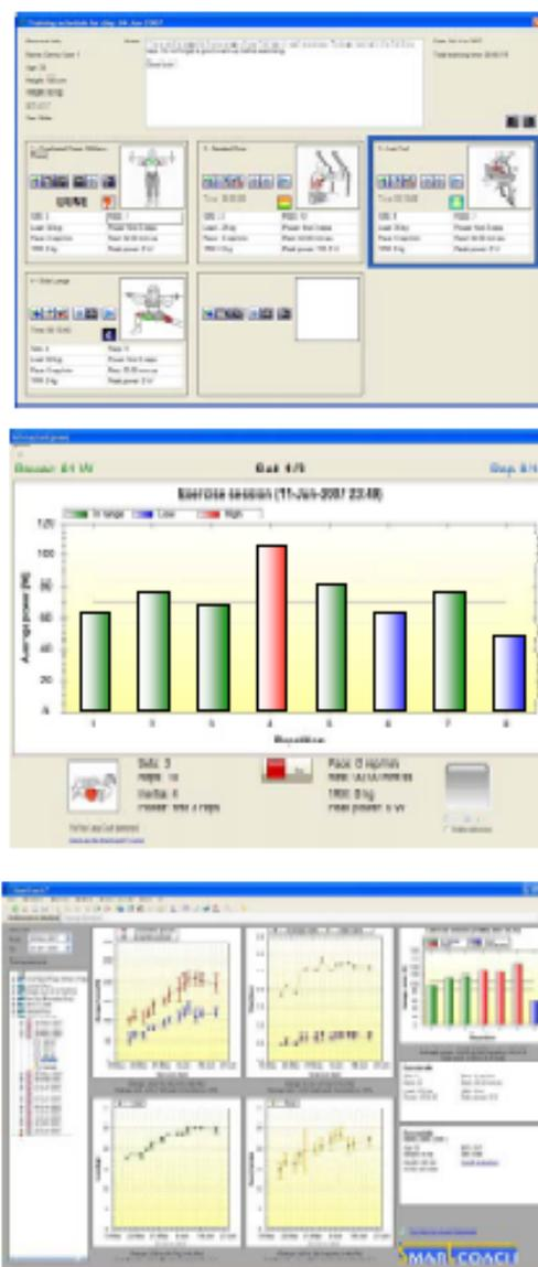
Figura 8: il software SmartCoach: in alto, piano di allenamento con gli esercizi della giornata; al centro, funzione di feedback che misura la potenza in tempo reale rispetto ad una soglia prefissata; in basso, schemata di valutazioni dei progressi che mostra l'incremento di potenza, lavoro ed altri parametri lungo la stagione di allenamento
